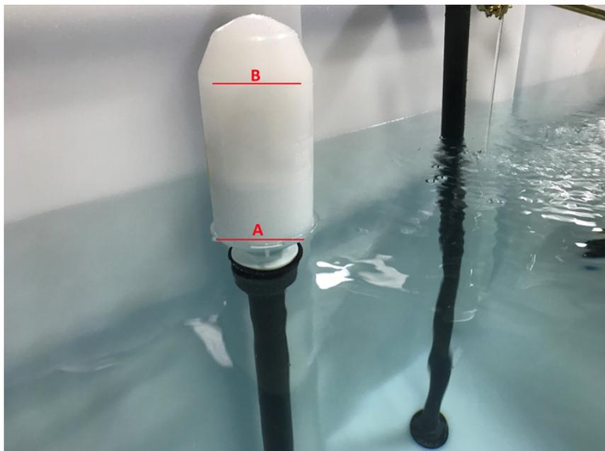
L'eau continue à sortir par le tuyau de trop-plein jusqu'à ce que le niveau de l'eau atteigne de nouveau le point A sur la vanne de décharge du siphon.
