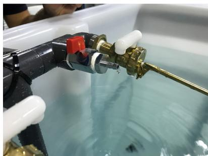
*Anpassung der Zuflussrate für eine höhere Wasserablassfrequenz – stetiger Wasserfluss*
